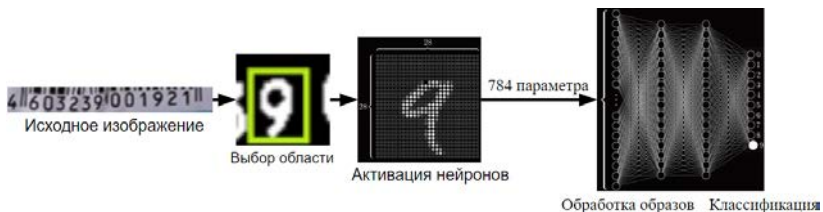
Рис. 4. Схема работы свёрточной нейронной сети для распознавания числовой последовательности
