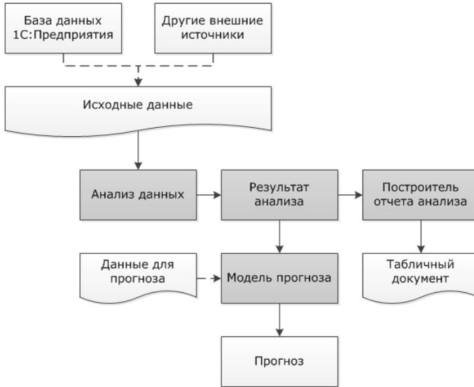
Рис. 1. Общая схема работы механизма анализа и прогнозирования данных
