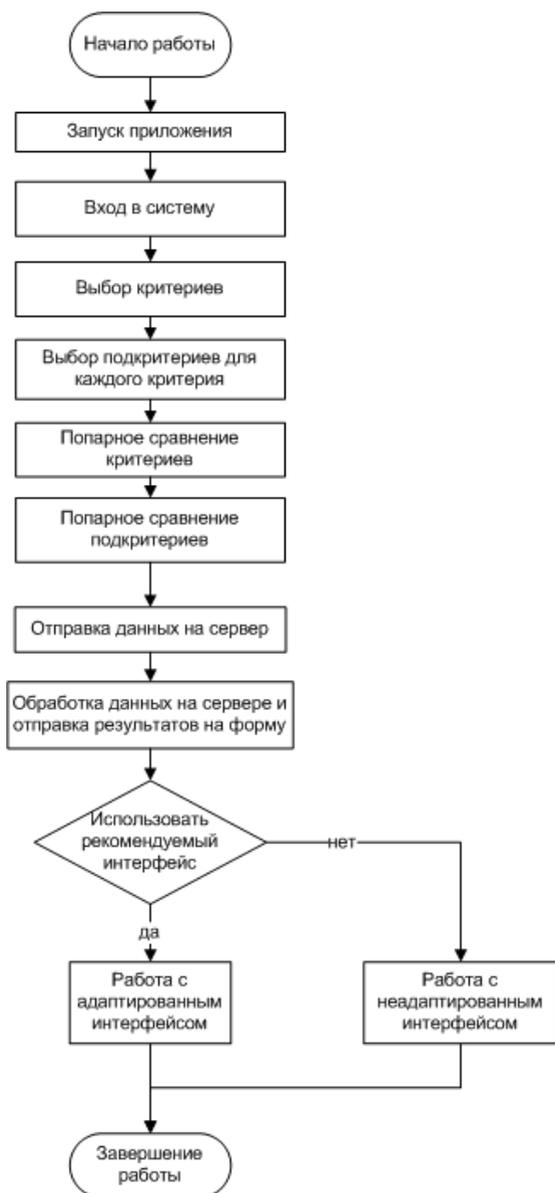
Рис. 2. Общий алгоритм работы пользователя с приложением для настройки внешнего вида графического интерфейса
