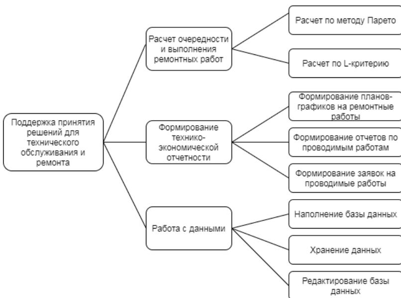
Рис. 2. Функциональная структура системы поддержки принятия решений
