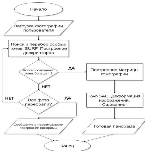
Рис. 1. Блок-схема алгоритма создания панорамы
