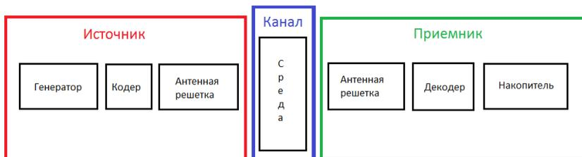
Рис. 2. Реальная модель технологии MIMO 2x2
