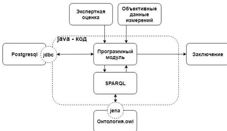
Рис. 2. Архитектура программной системы анализа информационной защищенности компании на основе онтологии
