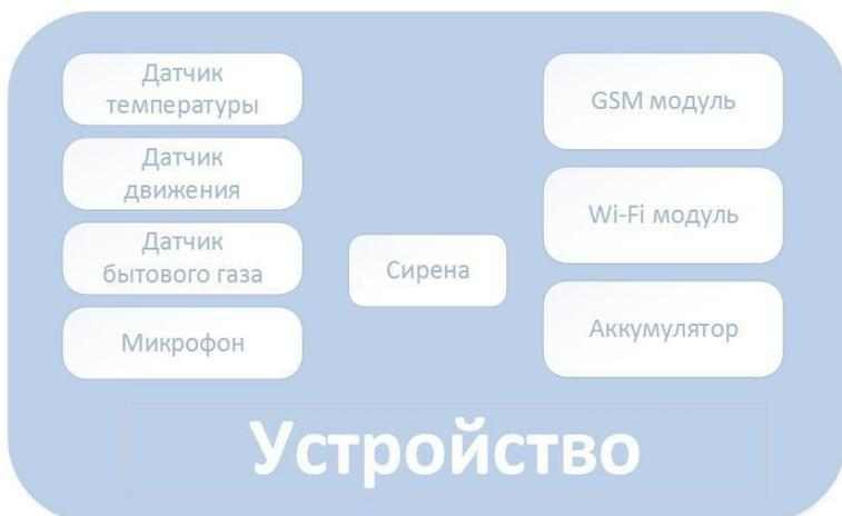
Рис. 2. Компоненты устройства
