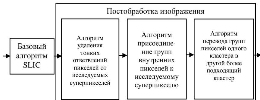
Рис. 2. Блок-схема модифицированного алгоритма SLIC
