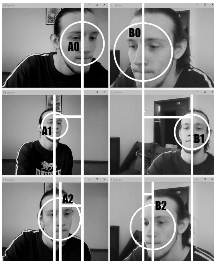
A0, B0 – базовые оси; A1, B1 – максимальные оси; A2, B2 – оси текущего изображения
