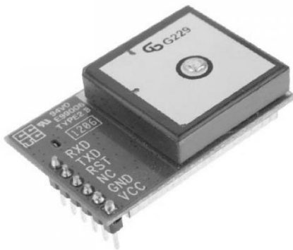
Рис. 1. Приемный модуль Skylab GPS SKM53
