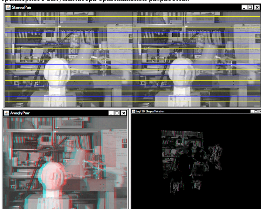
Рисунок. Формирование анаглифного стереоизображения и реконструкция облака точек
