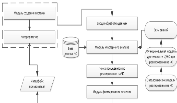
Рис. 2. Структурная схема (архитектура) программного обеспечения по определению количества необходимых сил и средств для реагирования на ЧС
